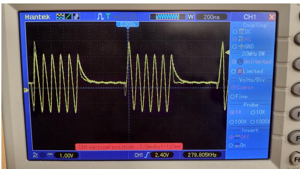
Figura 14: Señal de salida con punta  $x1$  del osciloscopio.
